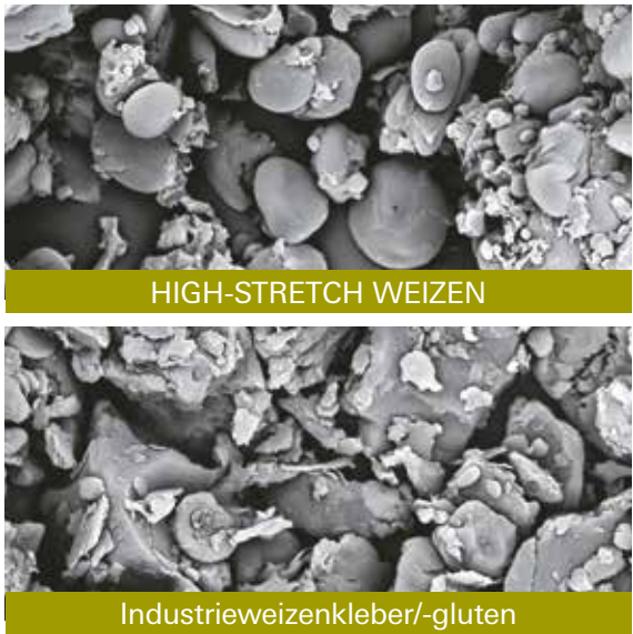
Rasterelektronenmikroskopie (REM): 2.000-fache Vergrößerung
